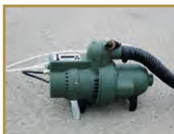
Gonfiatore/sgonfiatore con sistema di controllo della pressione.
