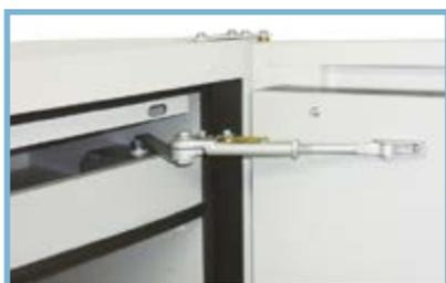
Nuovo sistema di chiusura che permette di mantenere le porte aperte in qualsiasi posizione. Sistema automatico di chiusura delle porte in caso di una temperatura ambiente superiore a 47 °C.
