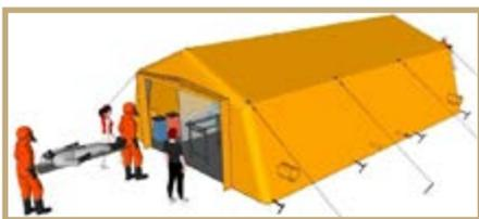
Esempio di una tenda di decontaminazione divisa in due linee (maschi/femmine) con prima sezione registrazione/spogliatoi, un'area centrale di decontaminazione e una finale per rivestirsi.
