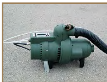
Gonfiatore/sgonfiatore con sistema di controllo della pressione.
