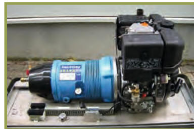
Compressore SmartComp montato su carrello a 4 ruote per facile trasporto.
