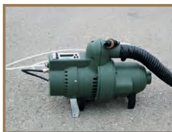
Gonfiatore/sgonfiatore con sistema di controllo della pressione.
