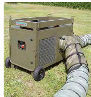
Climatizzatore esterno collegato alle tende tramite tubi per il passaggio dell'aria climatizzata
