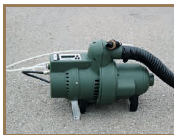
Gonfiatore/sgonfiatore con sistema di controllo della pressione.
