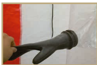
Sui lati della tenda vengono posizionati manicotti per poter operare dall'esterno.
